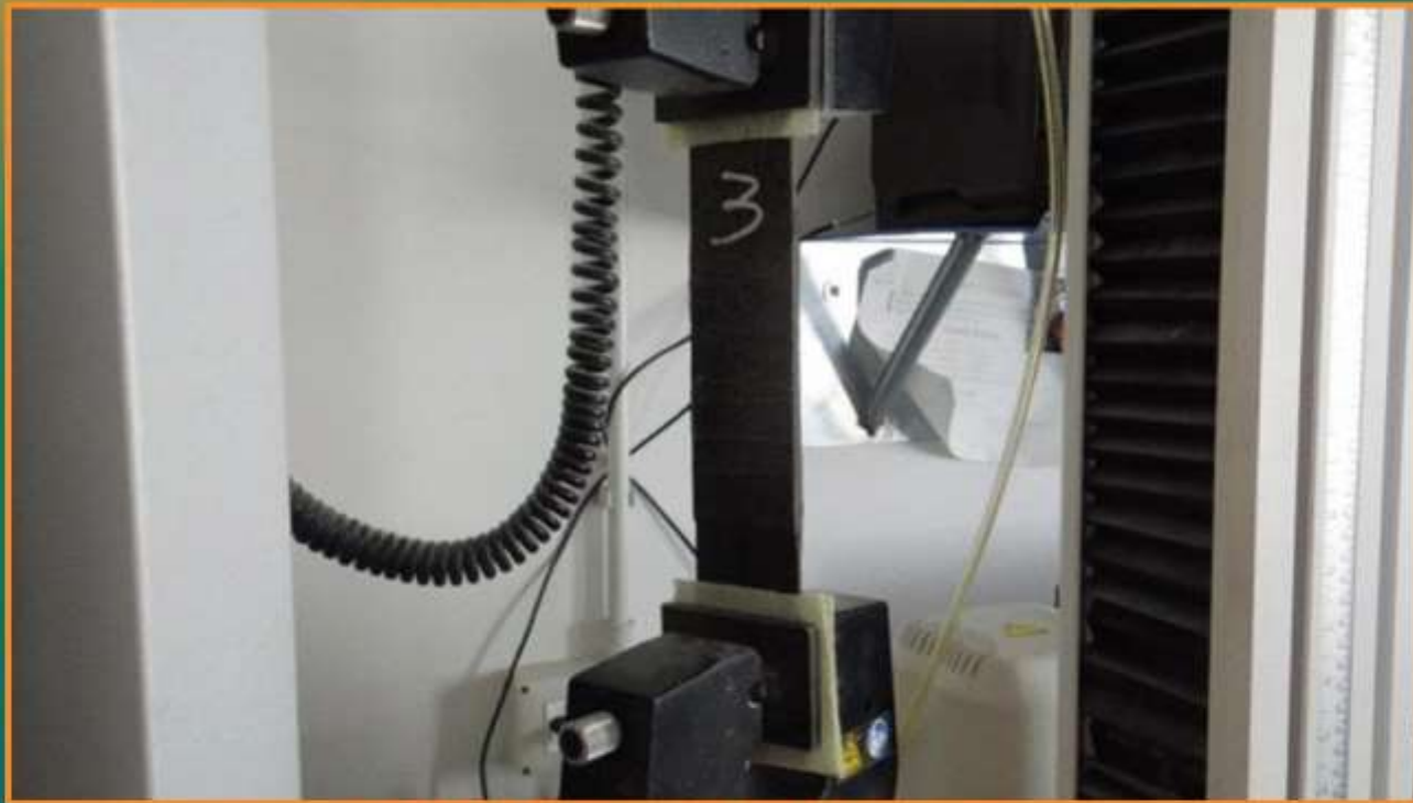
TEST DI TRAZIONE DELLA GIUNZIONE
