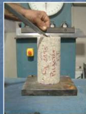
Molatura e controllo della planarità
