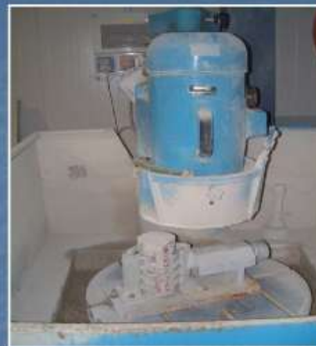
Molatura e controllo della planarità
