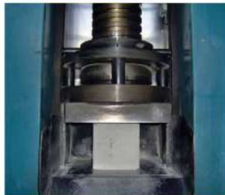
Nelle foto: Prova di compressione su calcestruzzo
