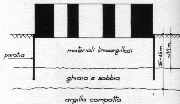
Fig. 11: Stabilizzazione della falda.
